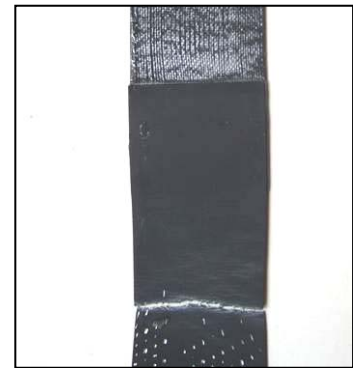
Fig. 122 : Rupture cohésive du métal pour 1 échantillon. Le zinc est complètement déformé.
