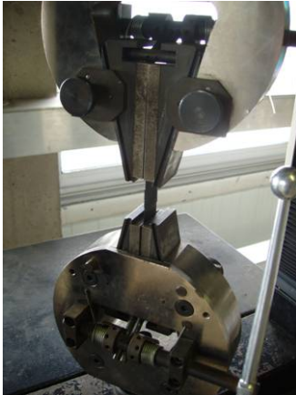
Fig. 116 : Échantillon en cours de cisaillement.
