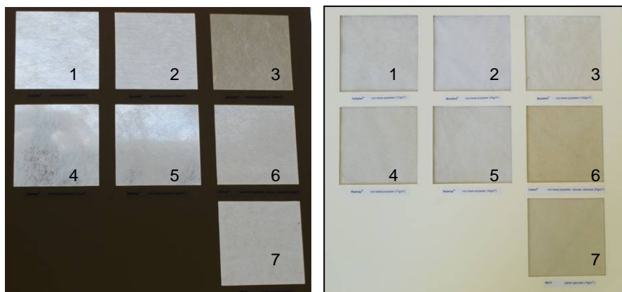
Fig. 163 : Sélection du matériau de comblement des papiers sur zinc. Observation de matériaux synthétiques teintés en lumière transmise et directe.
