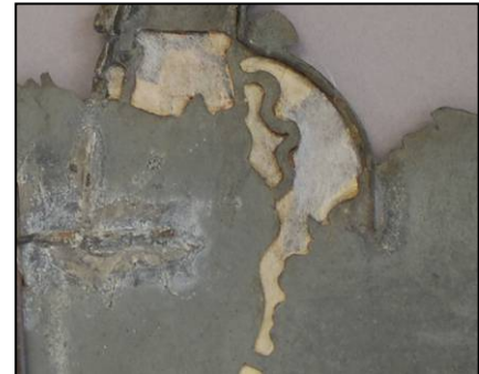
Fig. 165 : Doublage au papier japonais des parties lacunaires. Revers de la silhouette des Quatre cavaliers.
