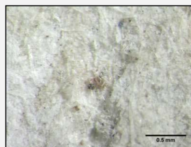
Fig. 82 : Même structure punctiforme constituée d'un cratère blanc et d'une boule noire centrale, Photographie sous loupe binoculaire.
