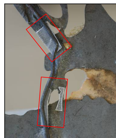
Fig. 156: Doublage des zones de bris, revers des quatre cavaliers : Les renforts en stratifiés sont ajustés aux zones de bris avant collage.
