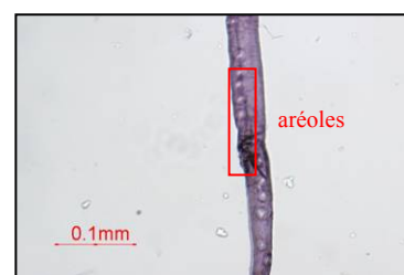
Fig. 33 : Détail d'une fibre de résineux ( Guerrier ) : identification par la présence d'aréoles ainsi que par la coloration.
