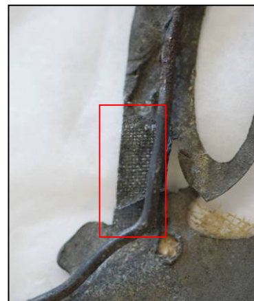
Fig. 155 : Doublage des zones de bris, revers des quatre cavaliers : la fibre de verre imprégnée de Paraloïd ® B72 est collée sur le zinc.
