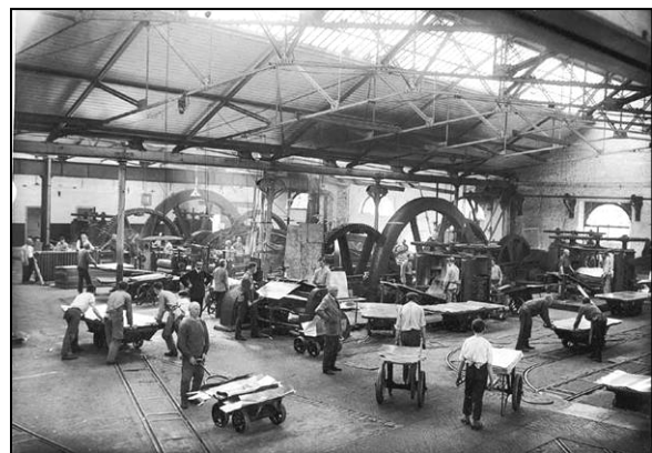
Fig. 36 : Le laminoir à tôles de zinc de la Vieille Montagne à Tilff, Belgique, vers 1900. ©Université de Liège-Centre d'Histoire des Sciences et des Techniques.
