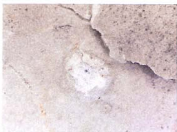
Tache blanche : formation d'un « cratère » sur le papier avec particule foncée au centre
